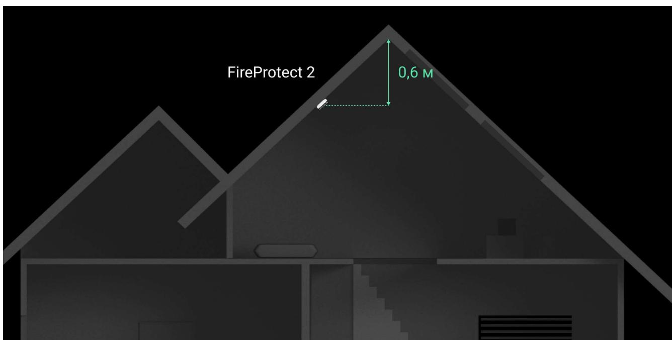
Не рекомендуємо встановлювати датчик на стіну. Таке встановлення допустиме, якщо близько розташовані балки або інші перешкоди заважають встановленню датчика на стелі. Встановлення на стіну можливе лише у випадку, якщо датчик розташовується на відстані 15–30 см нижче стелі, але вище дверних отворів.
